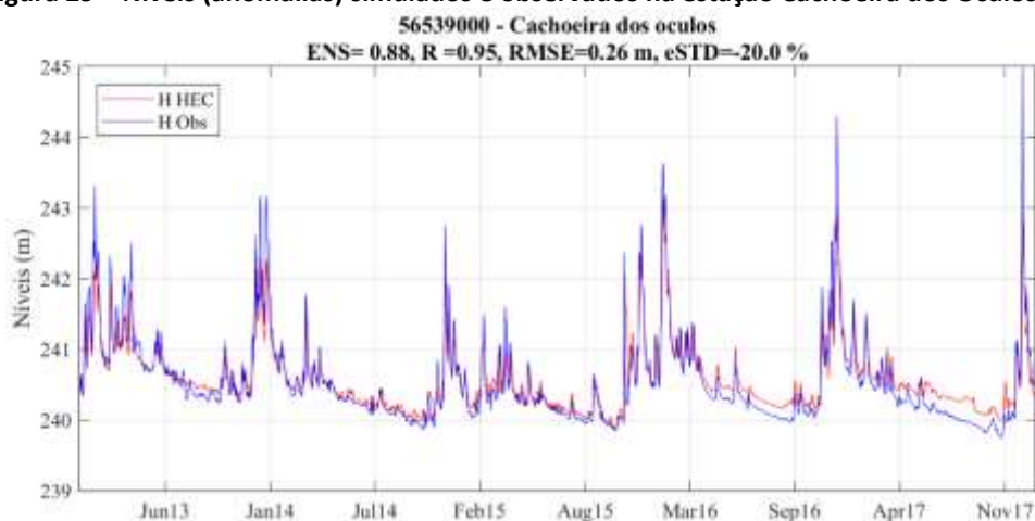
Figura 29 – Níveis (anomalias) simulados e observados na estação Cachoeira dos Óculos.
