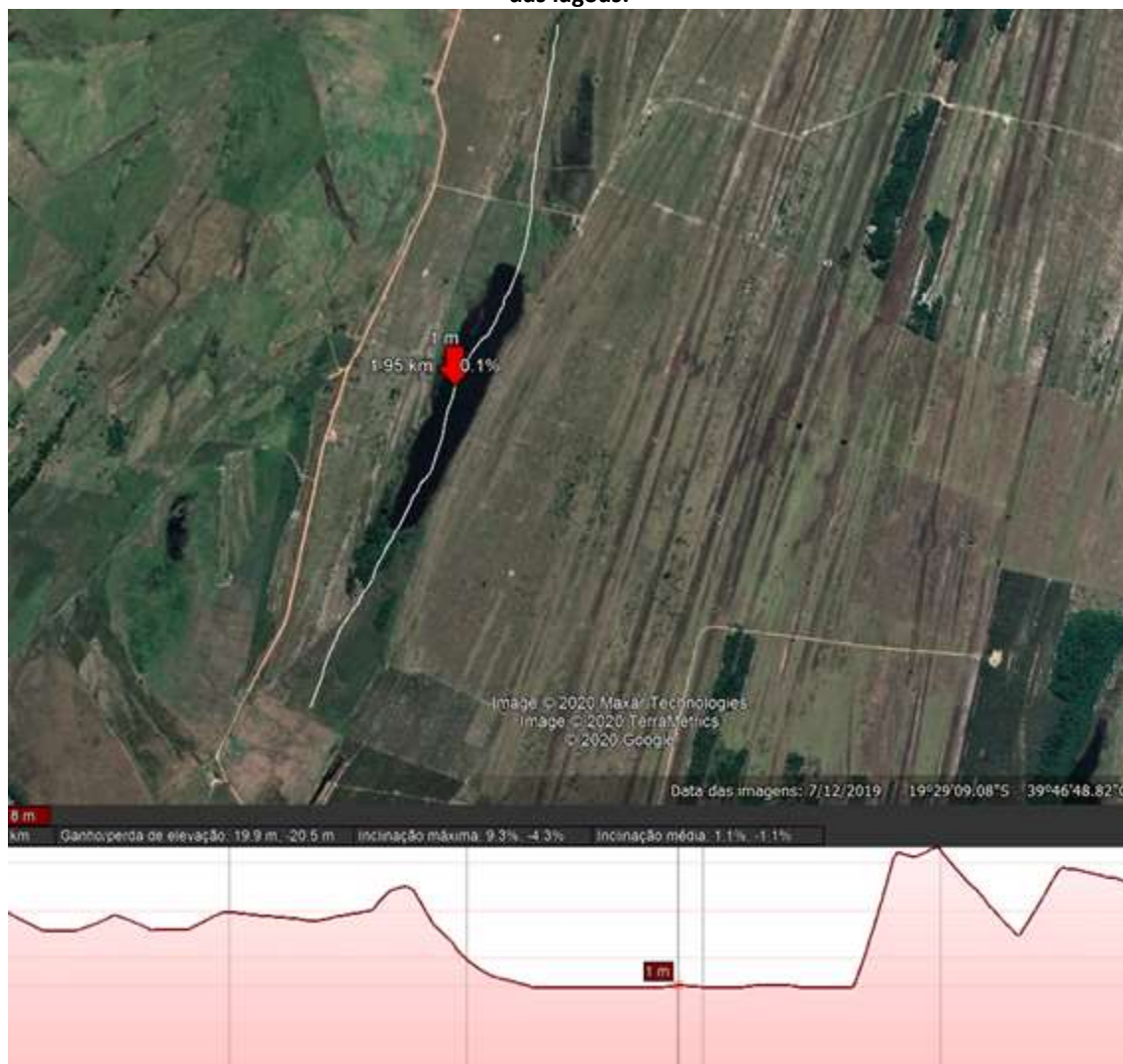
Figura 59 – Exemplo de perfil de elevação extraído do Google Earth para auxílio na estimativa das profundidades das lagoas.
