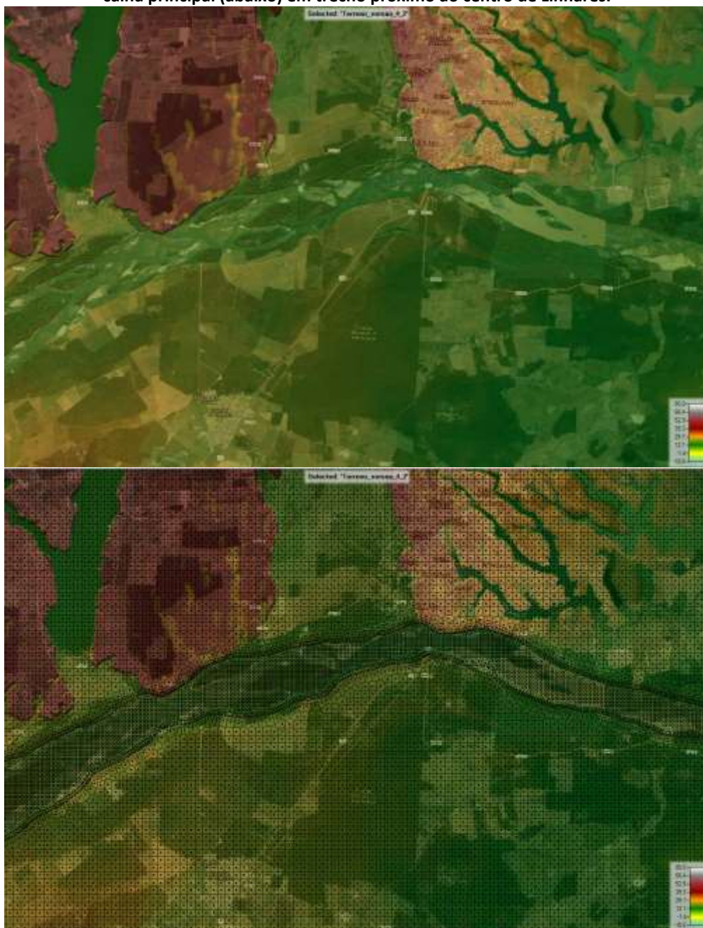
Figura 61 – Composição MDT e Google Earth (acima) e malha computacional em 200 x 200m com refinamento na calha principal (abaixo) em trecho próximo ao centro de Linhares.
