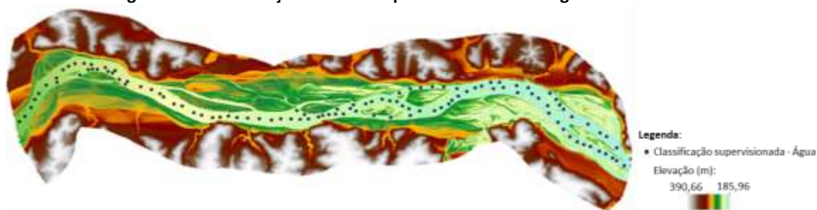
Figura 14 – Classificação manual de pontos referentes à água no leito do rio.
