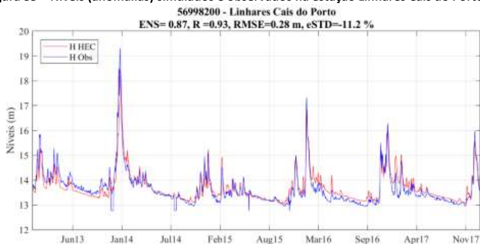
Figura 35 – Níveis (anomalias) simulados e observados na estação Linhares Cais do Porto.
