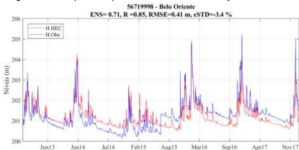
Figura 30 – Níveis (anomalias) simulados e observados na estação Belo Oriente.
