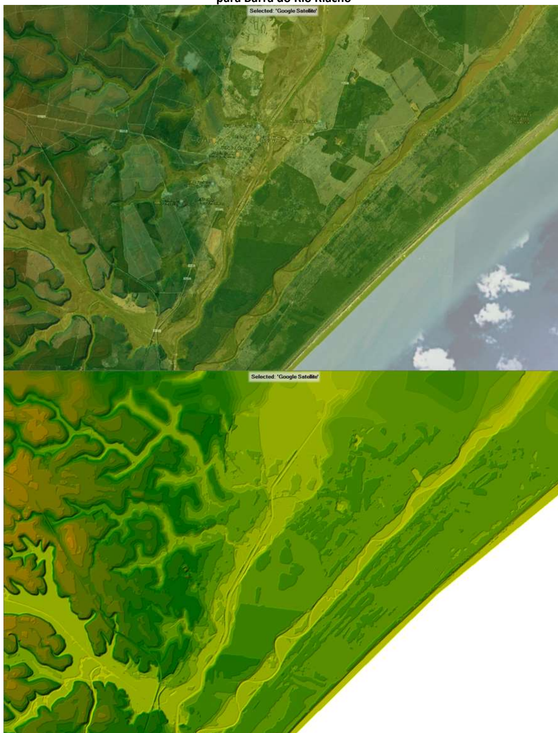
Figura 78 – Exemplo de canais identificados (acima) e escavado (abaixo) na margem direita do rio Doce – drenagem para Barra do Rio Riacho
