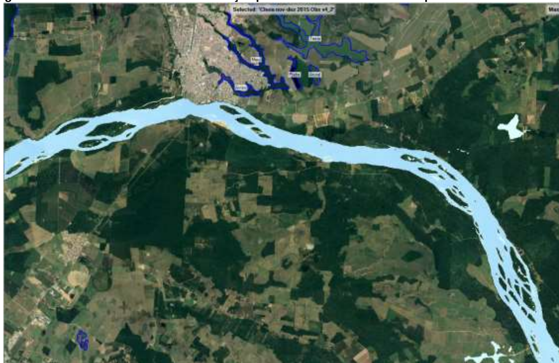
Figura 95 – Resultado da mancha de inundação para evento de nov-dez 2015 - próximo à área urbanizada
