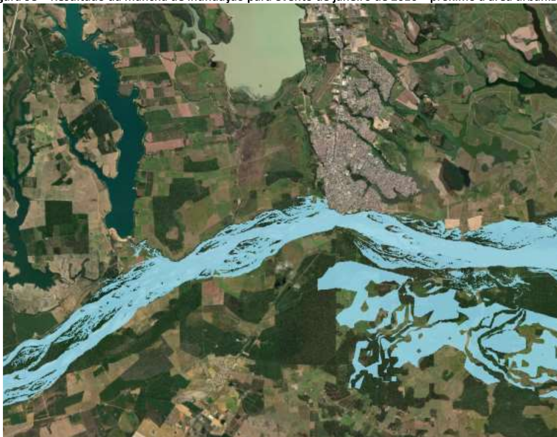
Figura 98 – Resultado da mancha de inundação para evento de janeiro de 2016 – próximo à área urbanizada
