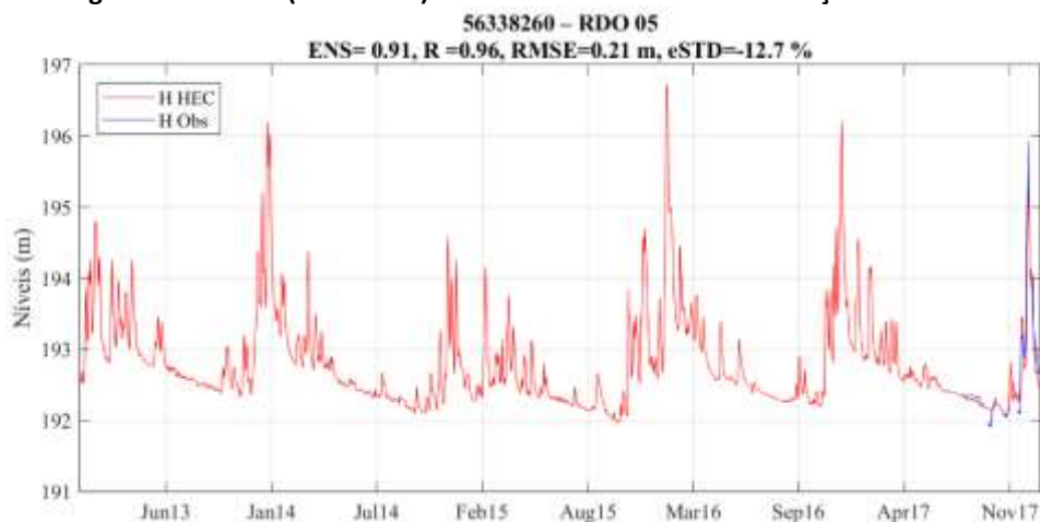
Figura 37 – Níveis (anomalias) simulados e observados na estação RDO 05.
