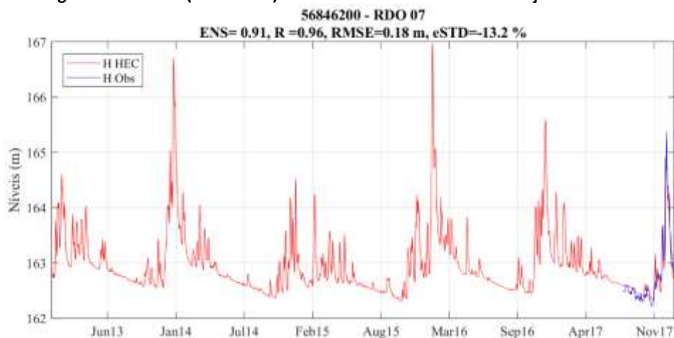
Figura 31 – Níveis (anomalias) simulados e observados na estação RDO 07.
