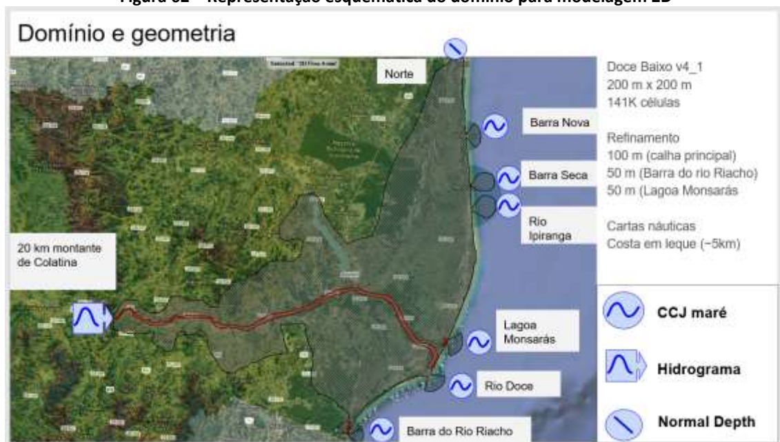
Figura 62 – Representação esquemática do domínio para modelagem 2D
