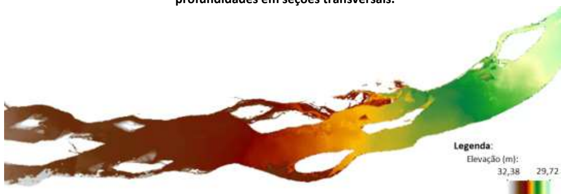
Figura 16 - Batimetria em trecho do Rio Doce, obtida através da interpolação pelo método Topo to Raster das profundidades em seções transversais.
