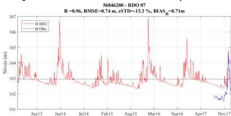
Figura 42 – Níveis absolutos simulados e observados na estação RDO 07.
